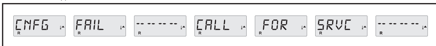
Slika 43: Dijagram poruke o pogrešci u konfiguraciji
